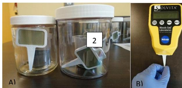
Fig. 1. A) L'incubation de l'échantillon de sol en laboratoire est réalisée dans un contenant hermétique en présence d'une sonde Solvita® qui absorbe le CO<sub>2</sub>; B) Le DCR permet d'associer une lecture d'une longueur d'onde à un résultat de C-CO<sub>2</sub> en ppm.
