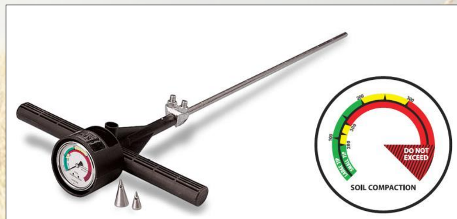
Figure 2. Le pénétromètre statique à cadran permet d'identifier les valeurs de CI maximales rencontrées pendant l'essai. Source : Adaptée de turf-tec.com (3)
